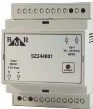
Napájecí zdroj 24VDC je v provedení na DIN lištu o velikosti 6x modulů. Slouží pro napájení digitálních čidel teploty, termopohonů TSH24V 24VDC a ostatních modulů systému.
