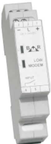
LOW MODEM může spolupracovat s GSM bránou, telefonním komunikátorem pro pevné linky nebo s ovládacím relé alarmové ústředny. Podle stavu ovládacích kontaktů přepíná regulátor z vytápění dle naprogramovaných režimů do útlumu ('LOW' režim) a zpět. Takto lze ovládat SMS zprávami přepínání režimu vytápění ve vzdálených objektech, kde není k dispozici internetové připojení.
