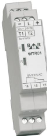
Modul je určen pro vyhřívání střešních oken pro systém RT64 nebo RNET64. Čidlo měří venkovní teplotu a porovnává ji s nastavenou teplotou z řídící jednotky. Jakmile je venkovní teplota nižší, zapíná se relé, které ovládá všechny topné fólie pod střešními okny.
