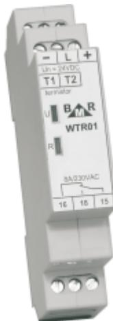
Modul je určen pro vyhřívání střešních oken pro systém RT64 nebo RNET64. Čidlo měří venkovní teplotu a porovnává ji s nastavenou teplotou z řídící jednotky. Jakmile je venkovní teplota nižší, zapíná se relé, které ovládá topné fólie pod střešními okny.
