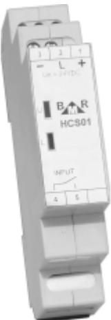
Pomocí modulu HCS01 lze přepnout soustavu z topení na chlazení a aktivovat chladicí režimy. Modul je vybaven vstupem pro externí zařízení. Jestliže je vstup modulu sepnut a zároveň alespoň jeden okruh má dle režimu chladit, systém se přepne na chlazení.
